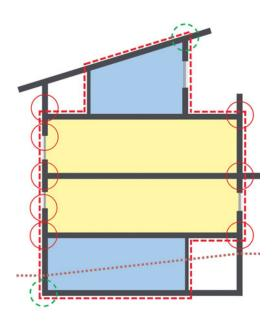
détails pertinents concernant les raccords chauffé non chauffé enveloppe thermique du bâtiment tracé du terrain
