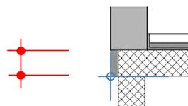
**Flankendämmung**      Wärmedämmung an Bauteilflanke
